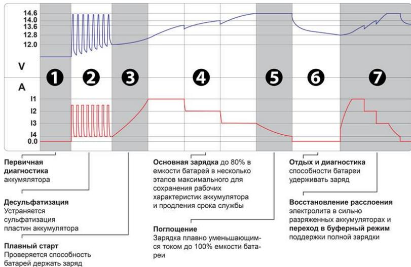
Система ступенчатой зарядки со встроенным микропроцессором :
