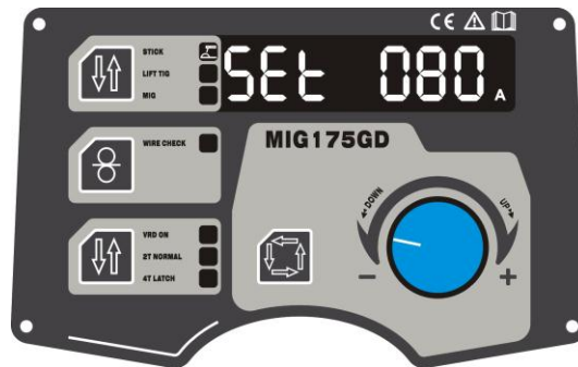
Рис 3: режим STICK, дисплей, VRD неактивен
