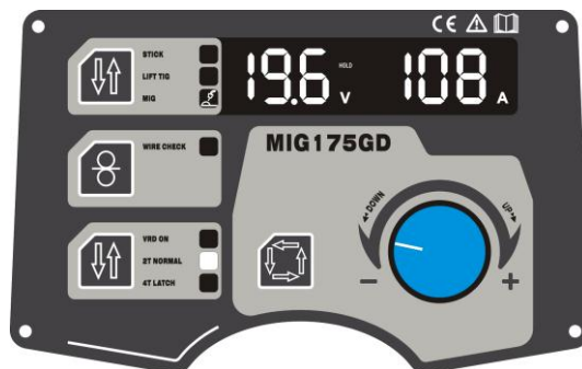
Рис 13: Дисплей после окончания сварки MIG
