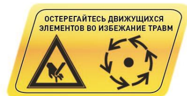
Рис. 2-12 Знак запрещающий прикасаться к вращающимся деталям аппарата во время работы клеится на руль
