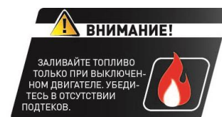
Рис. 2-6 Знак клеится на топливный бак
